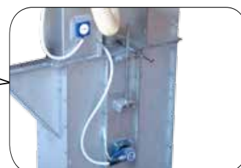
Czujniki kontroli prowadzenia taśmy i obrotów
