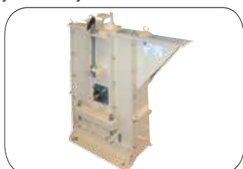
Stopa o zredukowanym poziomie pozostałości produktu
